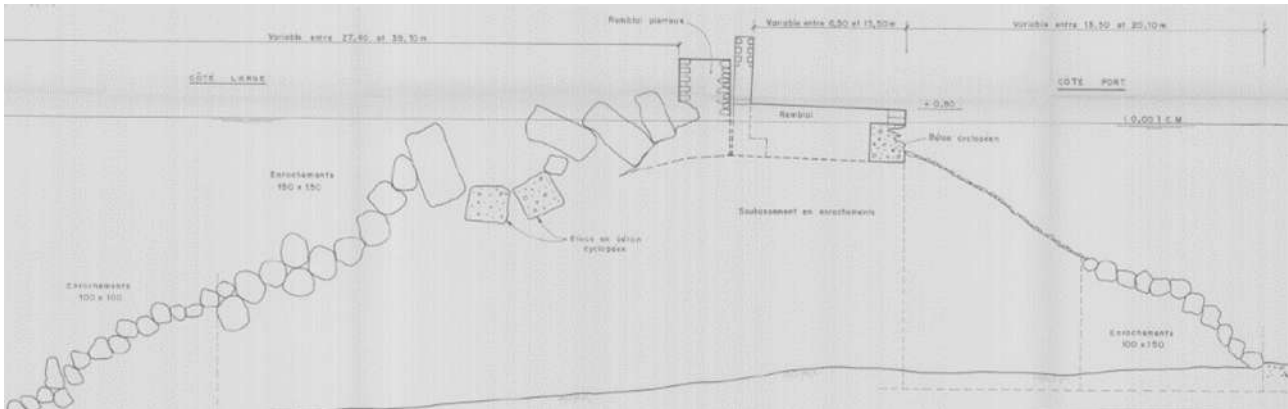
FIGURE 5 - PROFIL DE LA DIGUE EN 1995 - SOURCE SOGREAH 1995
