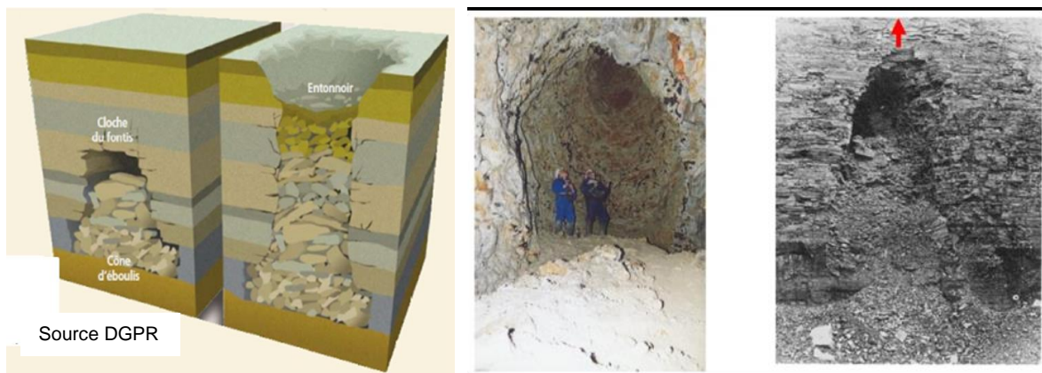
Figure 3: Schéma et exemples du mécanisme de remontée de cloche de fontis à l'origine d'un effondrement localisé
