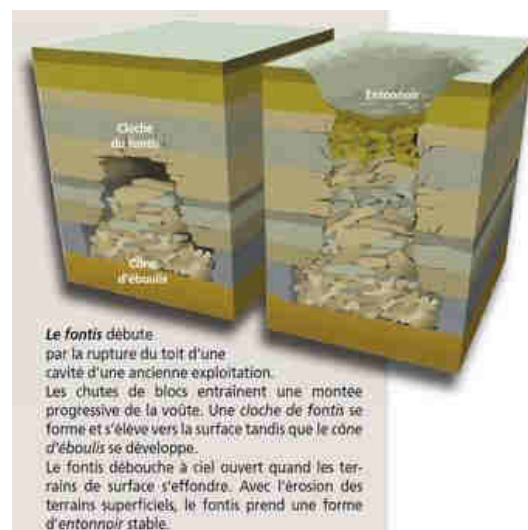
Illustration du phénomène d'effondrement localisé
