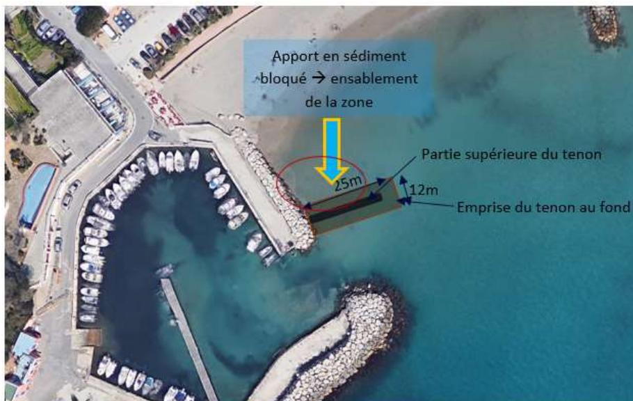
Figure 47 Ouvrage Tenon - scénario retenu – Suez, 2020
