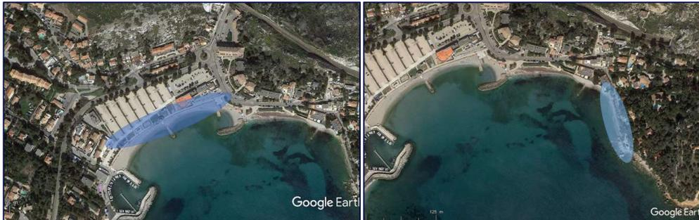
Figure 60 : Position des murs réfléchifs en haut de plage et à l'est du secteur
