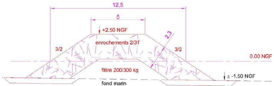
Figure 5 : coupe type de l'ouvrage de protection de la cale de mise à l'eau, Ref [2] 2005, Ref [4] 2006
