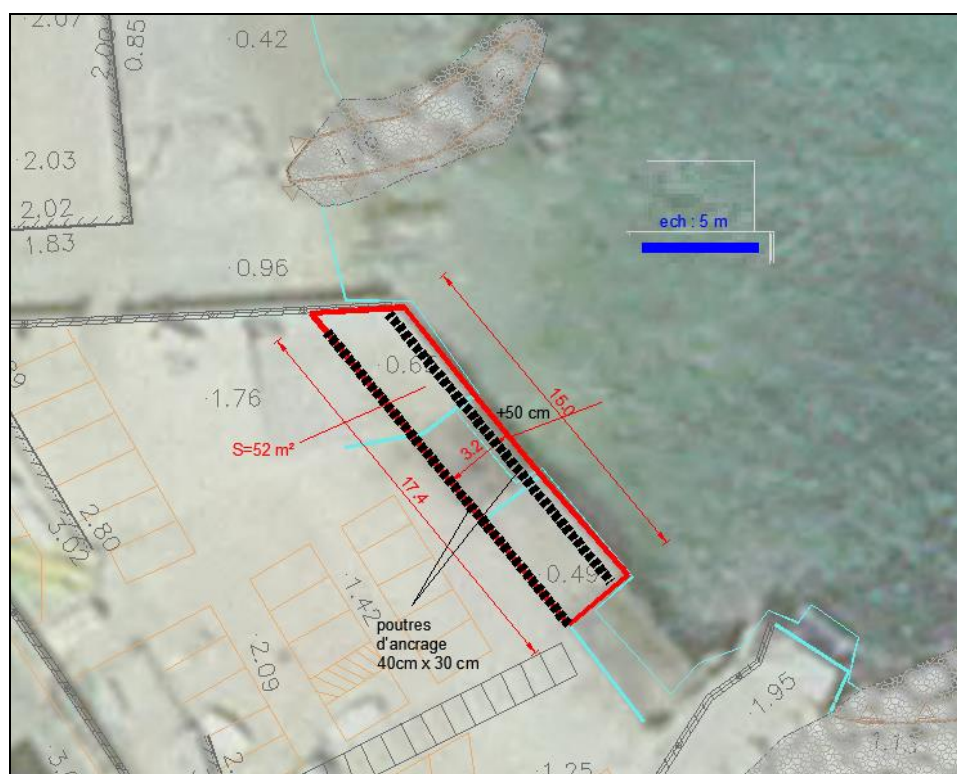
Figure 3 : Schéma de principe de la rehausse du quai
