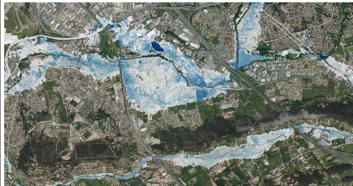
Résultat brut des hauteurs d'eau sans débordement sur la voie ferré
