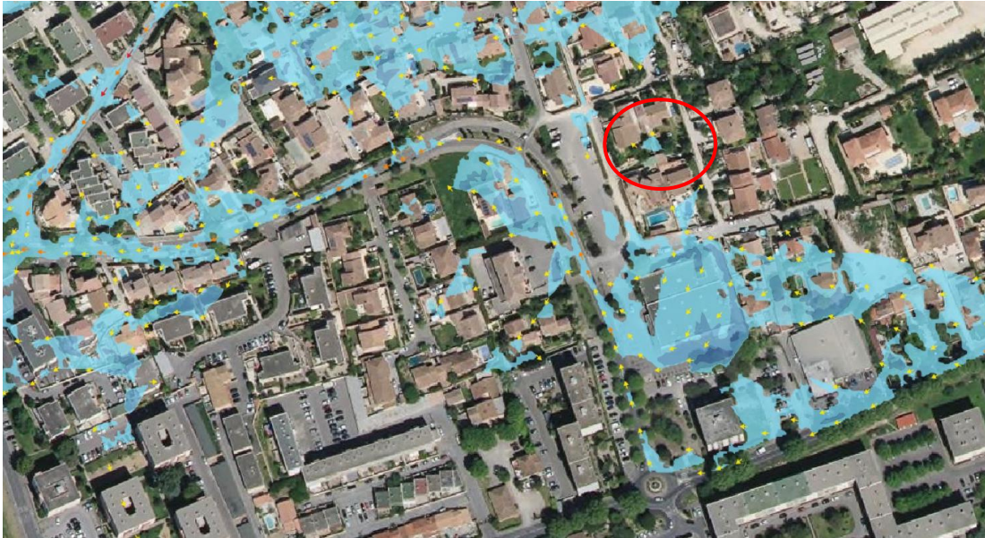
Figure 18 : Exemple de carte des hauteurs d'eau avec phénomène de « pastillage »
