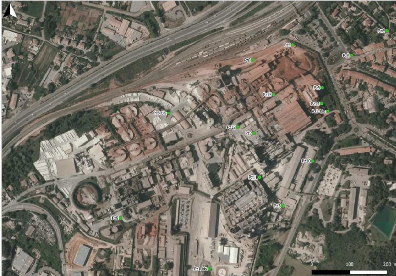
➔ Positionnement des piézomètres, en amont du site, répartis sur le site et en aval.
