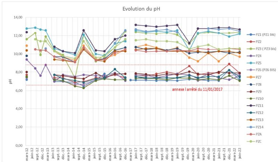
➔ Stabilité des mesures de pH sur la globalité des piézomètres, diminution progressive de Al sur le Pz11 le plus impacté (aval zone décomposition) et Pz3bis (aval atelier attaque).
