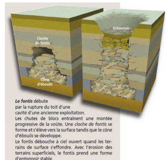
Illustration du phénomène d'effondrement localisé
