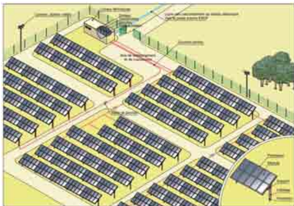
Principe d'implantation d'une centrale solaire (Source : URBASOLAR)
