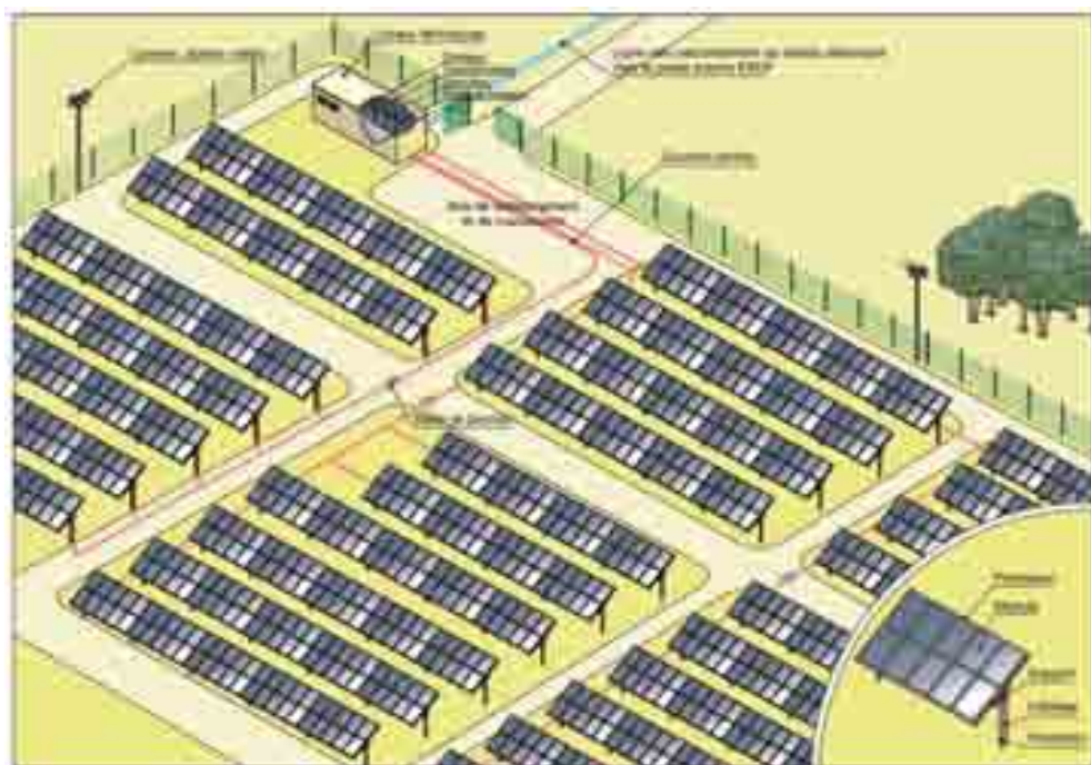
Principe d'implantation d'une centrale solaire (Source : URBASOLAR)
