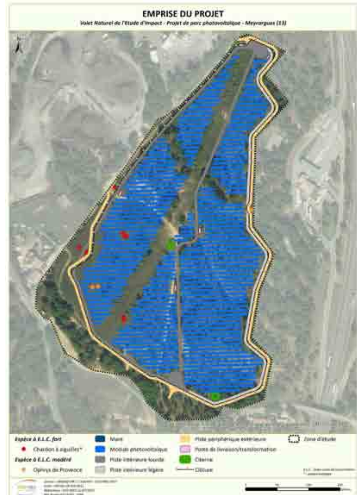
Carte 37 : Plan de masse prenant en compte les relevés complémentaires effectués au printemps 2017, évitant les stations d'espèces végétales protégées
