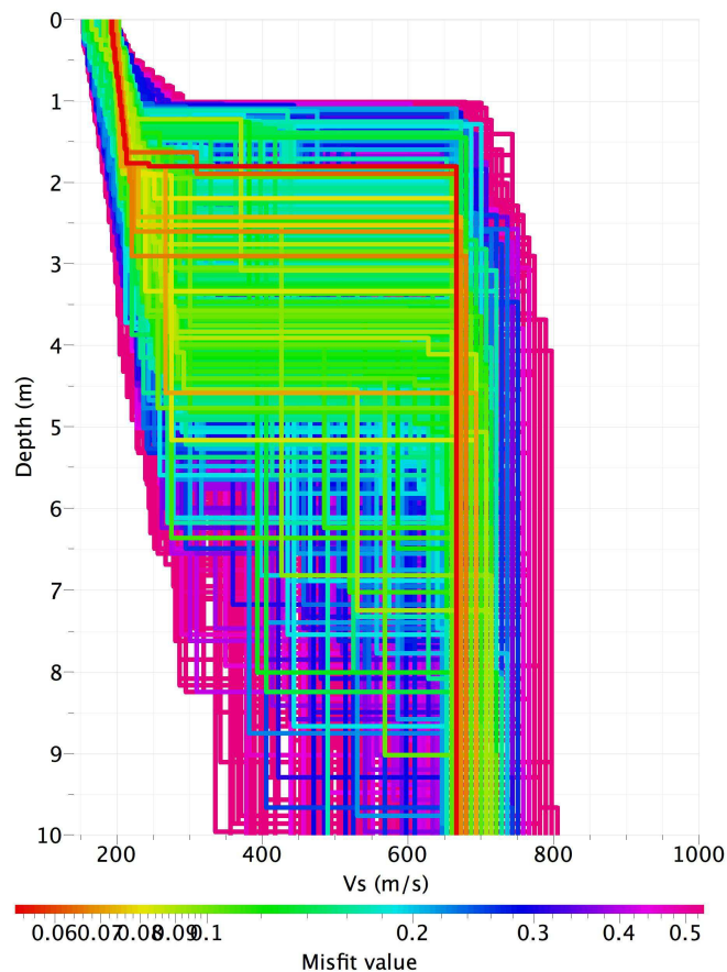
Figure 21 : Profil de vitesse de ondes de cisaillement (Vs) obtenu sur la zone Z6 par la méthode du bruit de fond en réseau.
