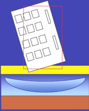
Quand un sol se liquéfie, sa résistance au cisaillement diminue et peut s'annuler, ce qui se traduit par une chute drastique de sa capacité portante et la mise à mal des structures qu'il supporte (*tassements, basculements*).
