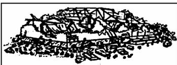
**Degré 5 (D5) : Destruction** (Dégâts structuraux importants)
