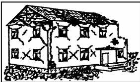
**Degré 4 (D4) : Dégâts très importants** (Dégâts structuraux importants, dégâts non structuraux très importants)
