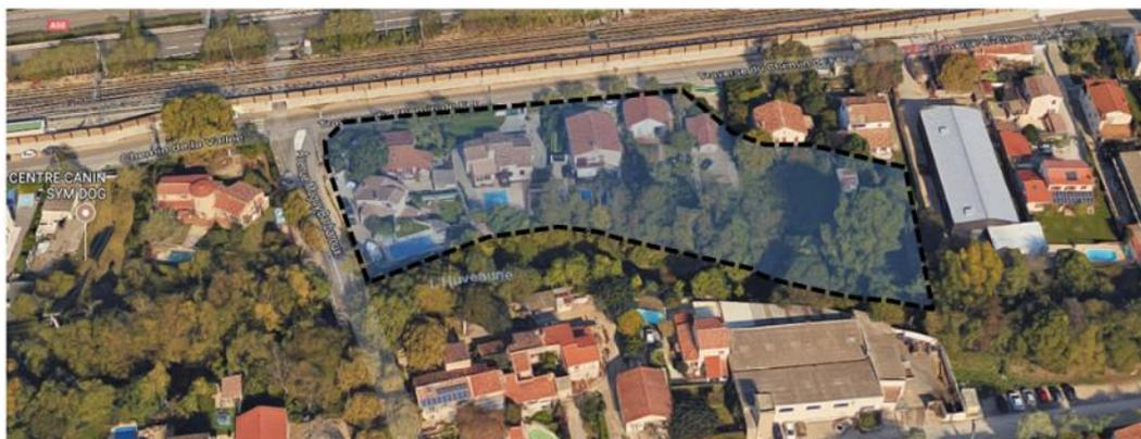
Figure 57 : vue aérienne du secteur avec dégradation des conditions de ressuyage (+25 cm, 1h après une crue centennale).
