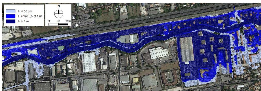
Figure 11 : Hauteurs de submersion calculées avec le modèle hydraulique en 2015 pour une crue d'occurrence 50 ans (275 m<sup>3</sup>/s).
