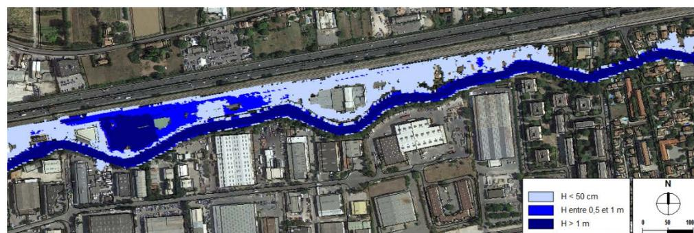
Figure 9 : Hauteurs de submersion calculées avec le modèle hydraulique en 2015 pour une crue décennale (135 m<sup>3</sup>/s).
