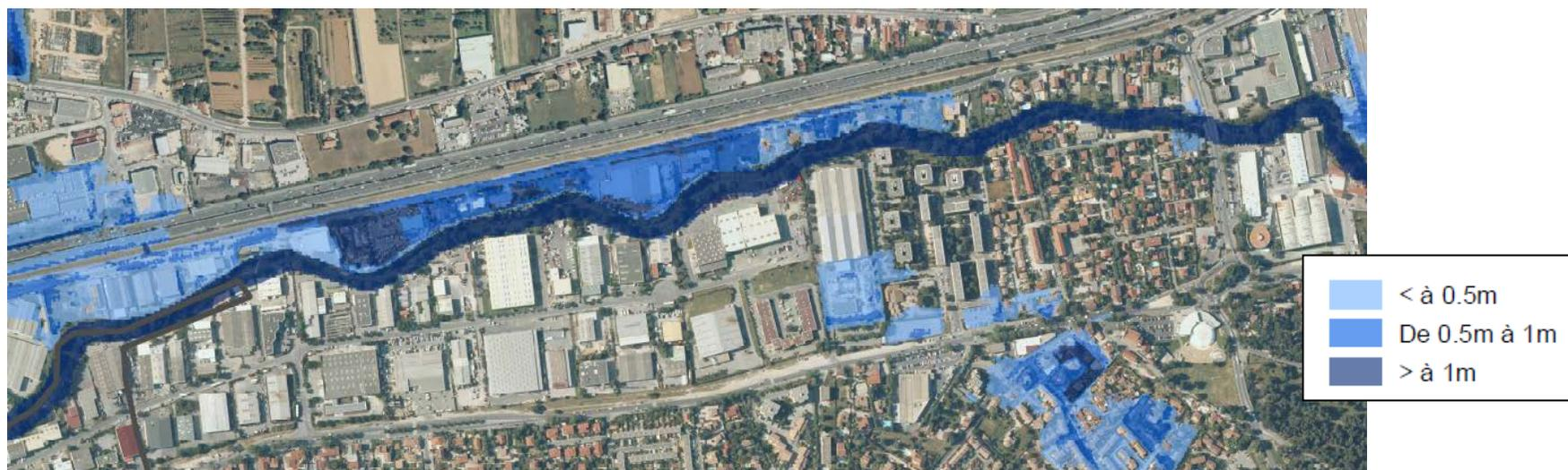
Figure 8 : Hauteurs de submersion calculées par EGIS pour une crue décennale (135 m<sup>3</sup>/s).
