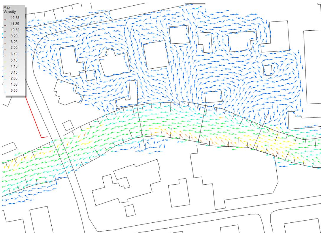
Figure 15 : Vitesses d'écoulement calculées par le modèle hydraulique pour un débit de 160 m<sup>3</sup>/s (Etat actuel) – secteur A.
