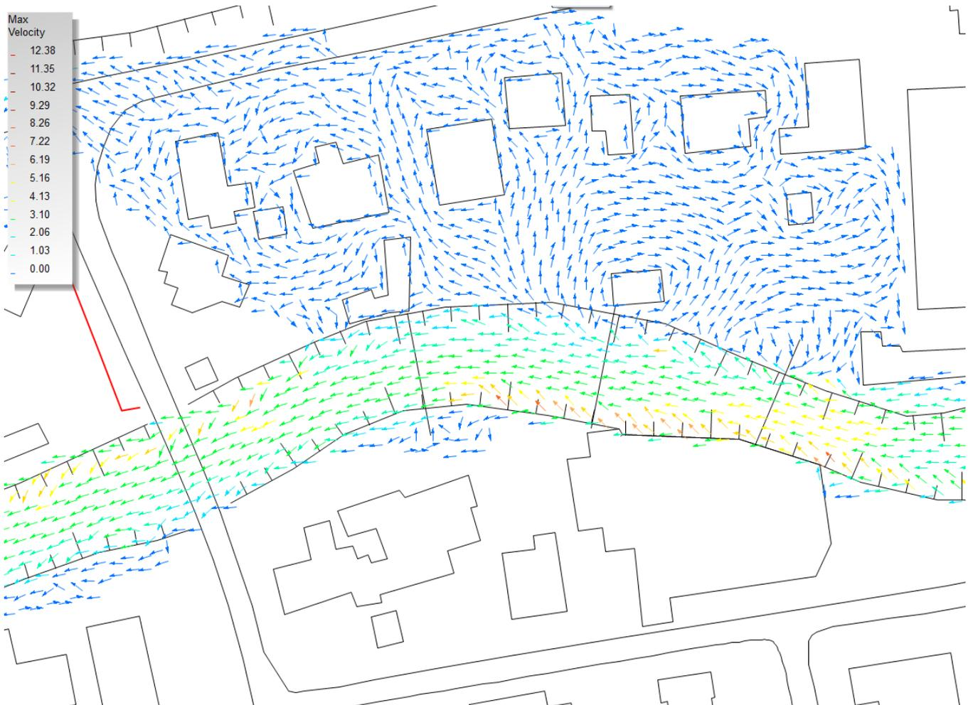
Figure 26 : Vitesses d'écoulement calculées par le modèle hydraulique pour un débit de 160 m<sup>3</sup>/s (Etat actuel) – secteur A.
