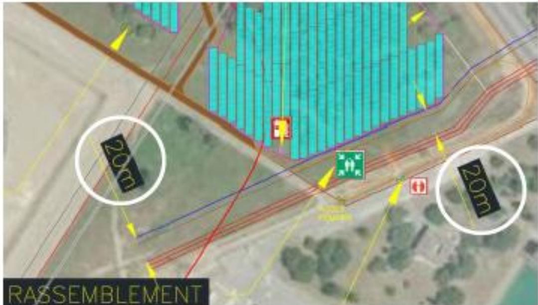
Figure 1 : Distance de retrait du pipe GEOSOL/Total Petrochemicals
