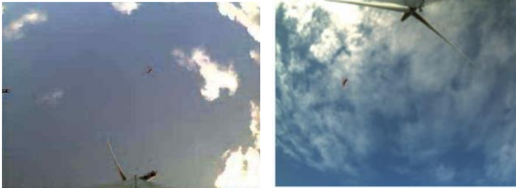
Figure 3 : Exemple de point de vue par le système de caméras sur les éoliennes (extrait de Nina 2012 et www.dtbird.com ). Plusieurs caméras sont installées en pied de mât et orientées vers le ciel, celles-ci permettent une observation de l'environnement aérien. Un logiciel de reconnaissance permet la détection d'oiseaux et entraîne le déclenchement d'un signal sonore.
