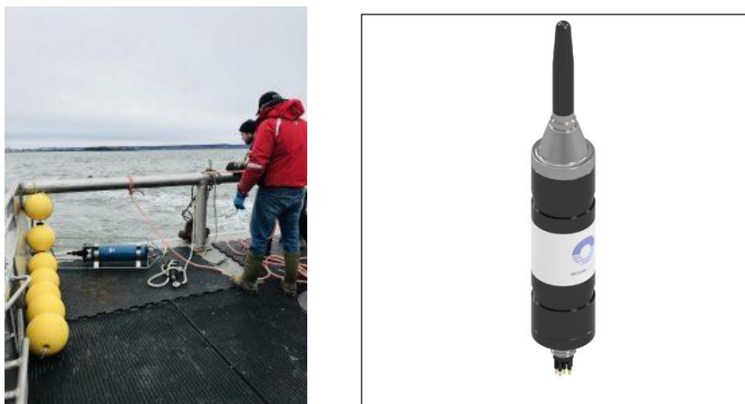
Figure 5 : Exemple de mise à l'eau d'hydrophones et de CPODs pour mesurer le bruit sous-marin.
