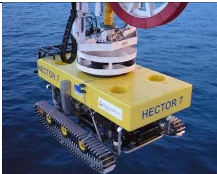
Déploiement d'un robot sous-marin téléguidé (ROV) en charge d'ensouiller le câble post-installation
