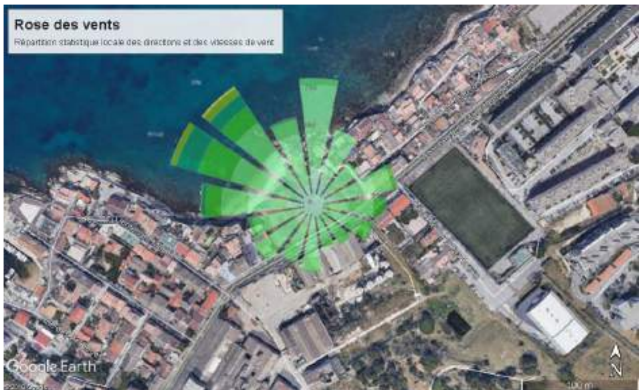
Figure 11 : Rose des vents annuels à Marseille superposée sur la zone du chantier
