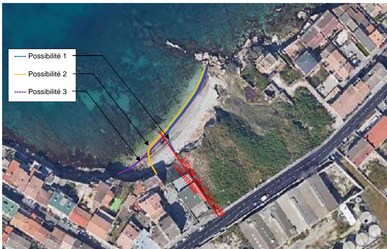
Figure 4-6 : Représentation des possibilités d'emprise de l'ouvrage de protection du crassier (limite extérieure)
