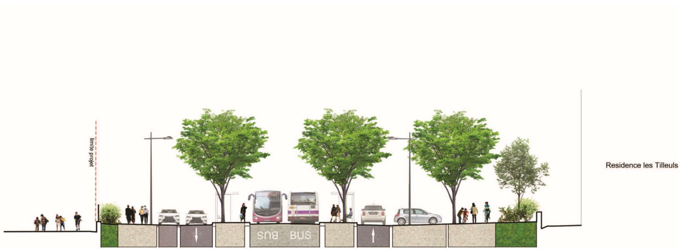
Figure 35 - coupe type des aménagements au droit de la station Sévigné
