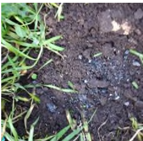
Figure 66 : Présence de matériaux anthropique dans les sols (pas d'enregistrement PID associé à ces constats organoleptiques)
