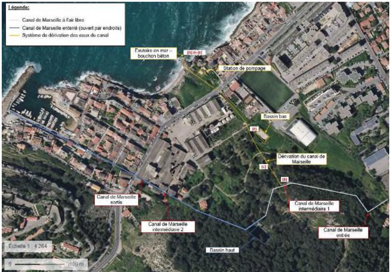
Figure 5 : Hydraulique et gestion des eaux sur site
