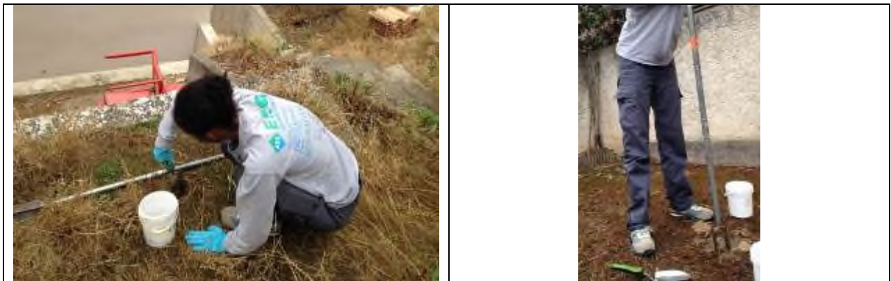
Réalisation des prélèvements de sols superficiels (tarière manuelle et pelle manuelle)
